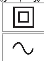
التيار المتناوب. الطقم يعمل فقط مع فلطية خط التيار المتناوب في شبكة الكهرباء في منزلك.
