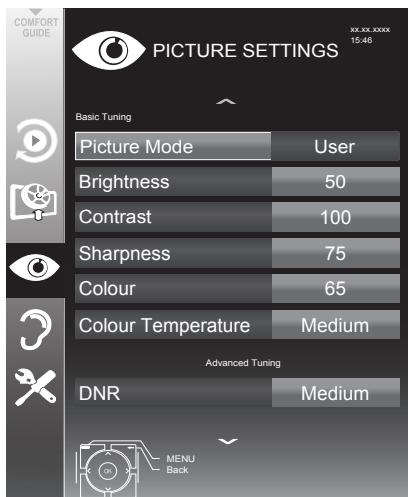
3 اختر سطر وضع الصورة «Picture Mode» أو «Contrast» أو «Brightness» أو «Sharpness» أو «Colour» أو «Colour Temperature» درجة حرارة اللون «Colour Temperature» باستخدام «▼» أو «▲» أو «OK». اختر القيمة باستخدام «<» أو «>» واضغط على «OK» للتأكيد.
